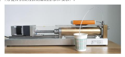
(2) 在键盘上选择 MENU-Fill/Empty-Fast Empty,控制器将快速清空,直到它安全的达到它自己的限位,这时体积压力控制器里的水与空气都已清空。
