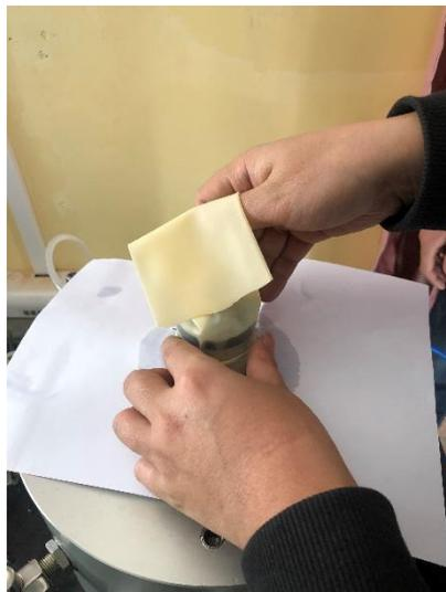
4、乳胶膜外安装好成型的三瓣膜装置，将乳胶膜顶部外翻包裹三瓣膜，检查内部是否紧密接触，无扭曲或脱空。小提示：此时可以用纸或者其他材料做一个防护措施，防止装砂土的过程中落入压力室底座中（如下图）。
