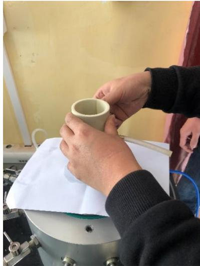
5、倒入砂土，制备试样。参照 2019 土工实验规范，建议分层压实，确保试样均匀。
